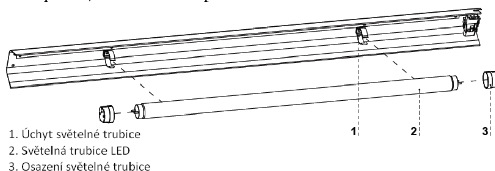
Obr.14 Výměna světelné trubice v osvětlení
